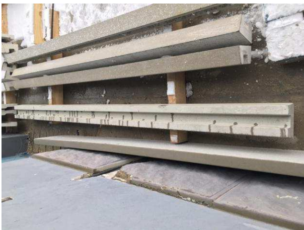
Foto 5 – Povrch dielcov po odformovaní
